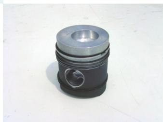
Kolben mit Ringen 610. Motor
