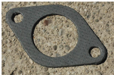
Dichtung zw. Krümmer und Auspuffrohr
