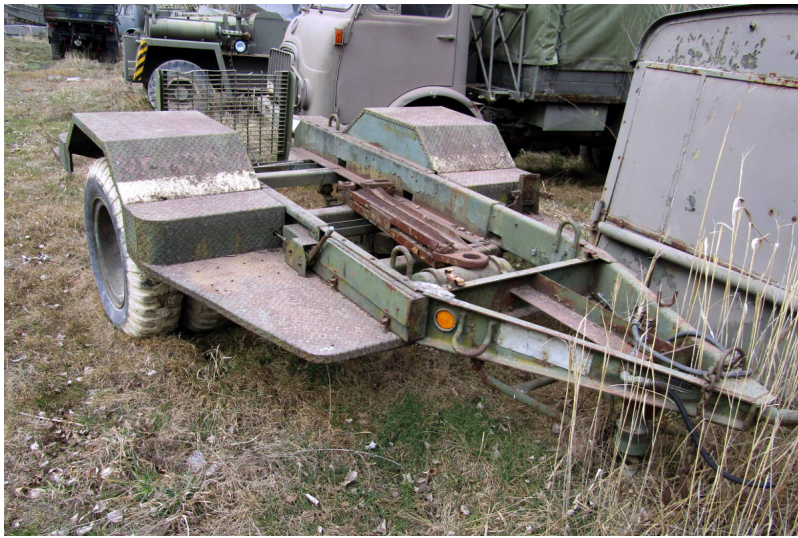
Einachsanhänger US Army für Stromaggregat
